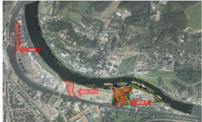
Bezpečnostní průleh – rozšíření ÚČOV vytvořilo bariéru pro vodu a dá se předpokládat, že při další významné povodni dojde k protřžení ostrova v místě navrženého bezpečnostního průlehu.
