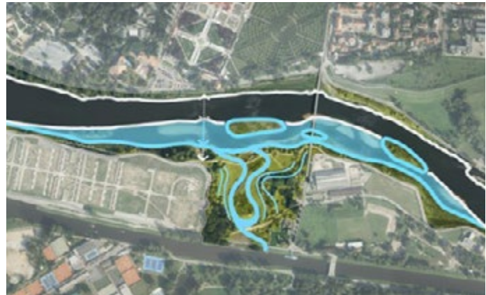
Rozšíření průtočného profilu – nárůst vodní plochy o 47%.
